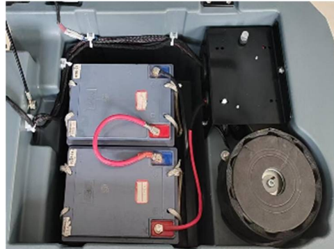
(řekil 4) Merkezi Kontrol ve Batarya
